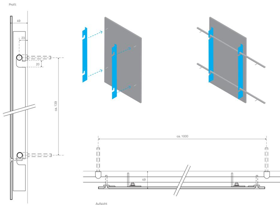
Schematische Darstellung Montageprinzip
